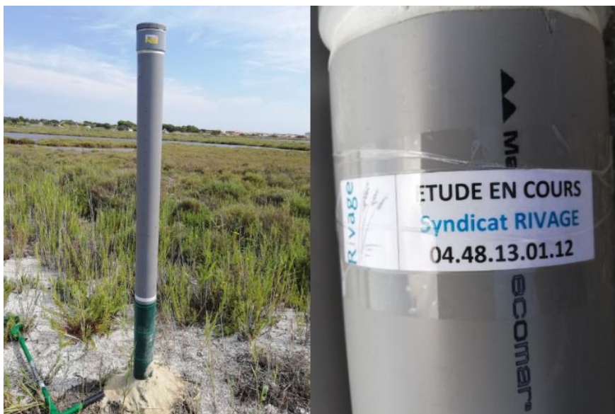
Figure 41 : Exemple d'un piézomètre (n°7)
